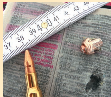
Nach dem Telefonbuchbeschuss: rechts der Geschossrest (68 Prozent Restgewicht)
