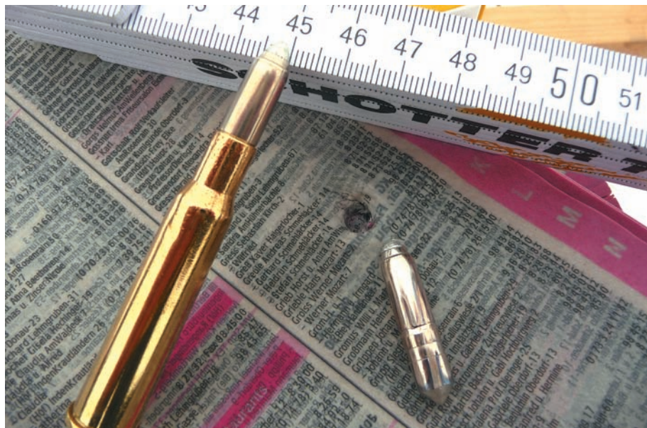
Anfangs nicht serienreif: eine zur Verfügung gestellte Laborierung mit 8,3-g-TIG Nature in der Randversion war zu langsam und pilzte im Gegensatz zur 7x57 nicht auf.
